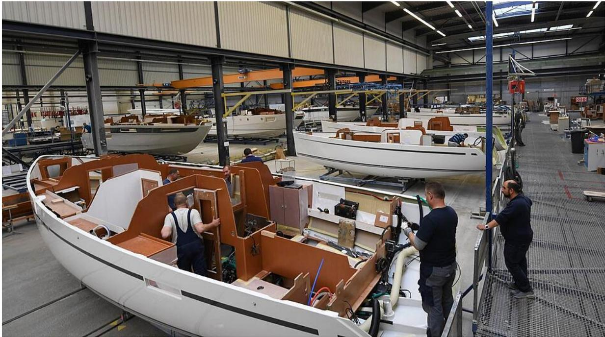
Ehe das Deck mit dem Rumpf "verheiratet" wird, erfolgt die komplette Möblierung des Innenbereichs. Millimeterarbeit ist gefragt, alles muss nahtlos passen. Foto: Ronald Rinklef
