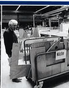
Lackieren und sortieren: Nach der Überprüfung rollen die fertigen Bauteile auf Wagen zur Holz-Montagehalle
