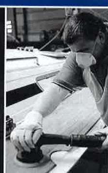
Feinschliff: Danach bleiben noch mindestens acht Millimeter Teak-Nutzschicht erhalten
