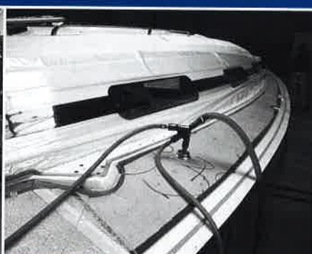
Unterdruck: Die kompletten Deckshälften aus massiven, zehn Millimeter starken Stäben und Trägerfolie werden mit Vergussmasse aufgelegt und per Vakuum-Verfahren angepresst, bis der Kleber trägt
