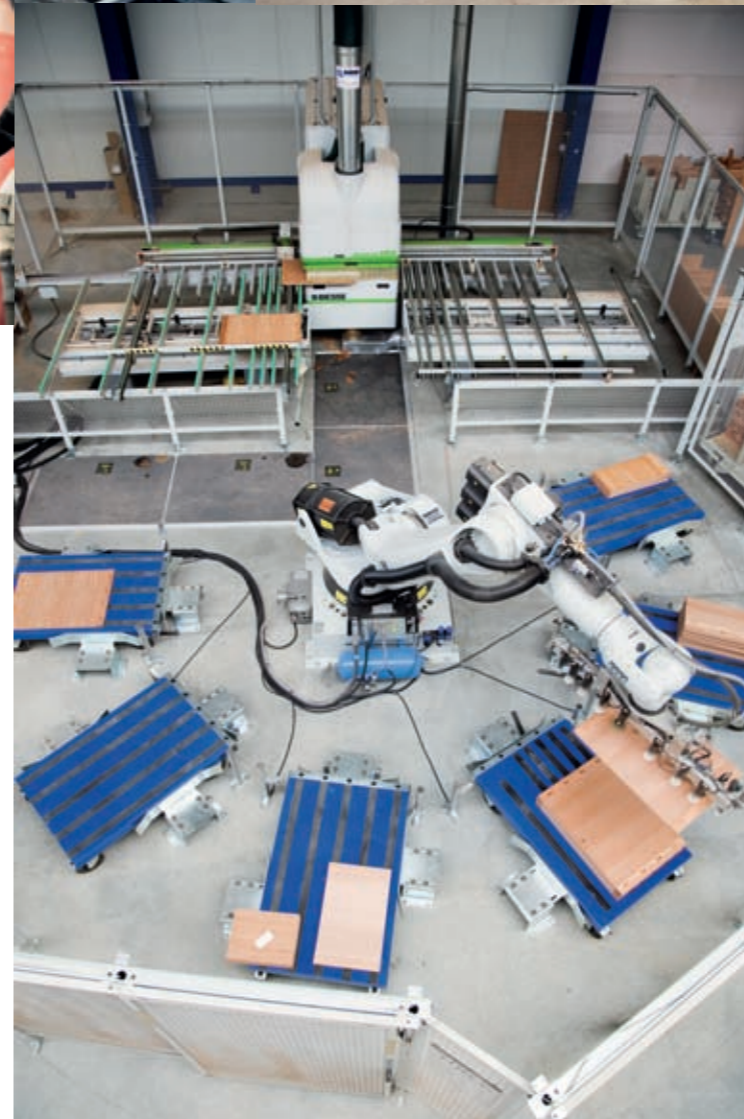
Ob Rumpffertigung (links oben) oder die Produktion von Möbeln (links): der Anteil an computergesteuerter Maschinen bei der Fertigstellung ist überproportional groß und ermöglicht bis heute einen kostengünstigen, industriellen Yachtbau, ohne dass auf Qualität verzichtet werden muss.
